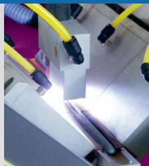
**Zusammenfügen** Besonders bei den Serien kommen unsere Schweissroboter zum Einsatz. Bei 90° Ecknähten setzen wir unsere Eckenschweissmaschinen ein. Diese bieten zauberhafte Schweissnähte, so dass eine weitere Bearbeitung unnötig wird. Dies spart Zeit und Geld, damit Ihre Teile noch günstiger werden.
