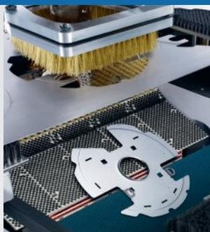
**Kombimaschine** Unsere High-End Stanz-Laseranlage vereint die blitzschnelle Stanztechnologie mit dem flexiblen Laserschnitt. In einem Schritt ist eine einzigartige Umformfähigkeit, Ansenken und Gewindeschneiden möglich. Ein Genuss von höchster Dynamik und beinahe kratzfreier Bearbeitung.
