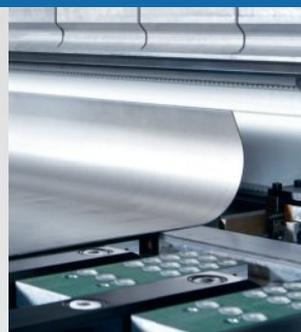
**Umformen** Neben den Robotern biegt unser Schwenkbiegezentrier Codatto® halbautomatisch. Kaum ist das Werkstück an die Maschine übergeben, übernimmt diese das Kommando und biegt die komplexesten Formen. Kratz- und beinahe biegeabdruckfrei. Dies ist ideal für Gehäuse und Profile aller Art.
