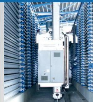
**Lager** Unsere Laser- und Stanzmaschinen sind am vollautomatischen Blechlager angeschlossen. Dieses umfasst bis zu 2000 Tonnen und bestückt die Anlagen rund um die Uhr mit Blechtafeln. Insbesondere unsere Serienmaschinen schneiden so Ihre Teile Tag und Nacht, schnell und preiswert.
